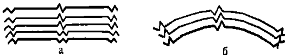
Рисунок 2.4 – Схема формирования анизотропных (а) и изотропных (б) структур в коксах
