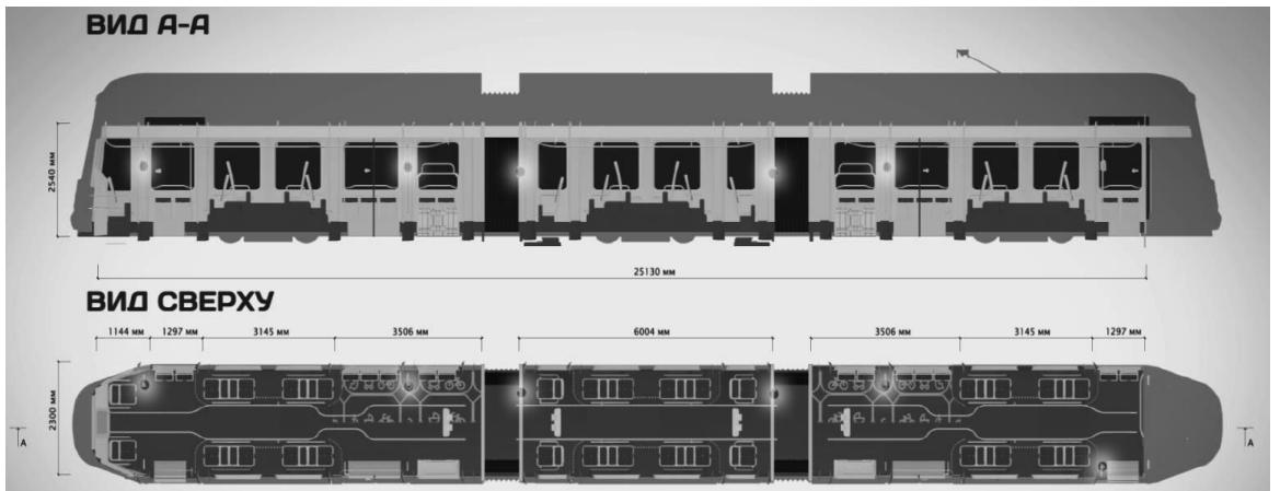
Рис. 18. Схема расположения валидаторов
