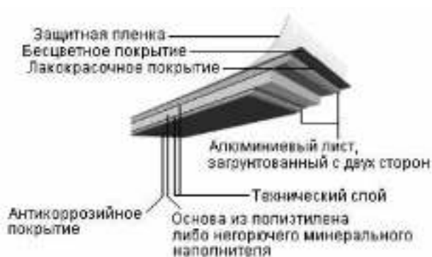
Рис. 32 Устройство композитной панели.
