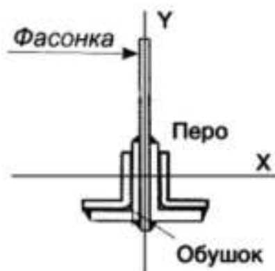
Рисунок 46. Сечения стержня сжатого пояса
