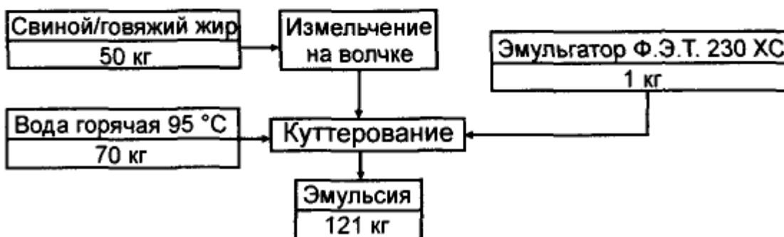
Рисунок 4 – Получение устойчивых водожировых эмульсий при холодном и горячем способах
