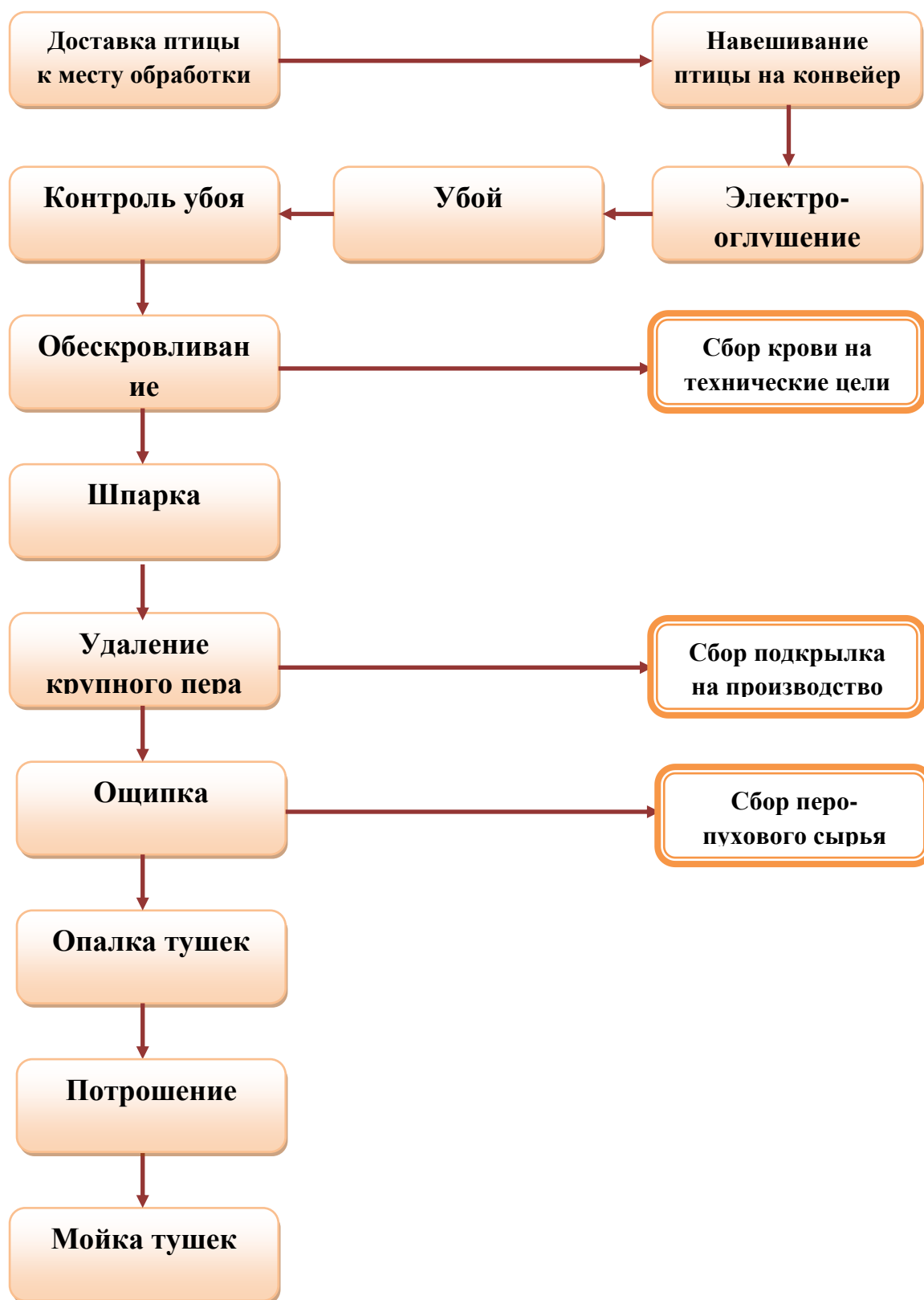
Схема технологического процесса убоя птиц
