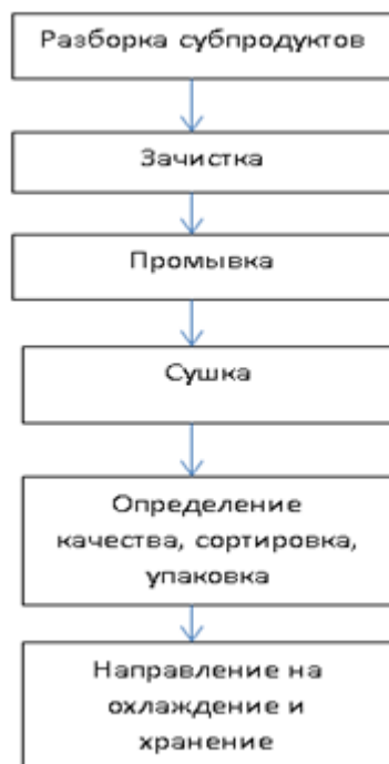
Рисунок 3 –Технологическая схема обработки мякотных субпродуктов
