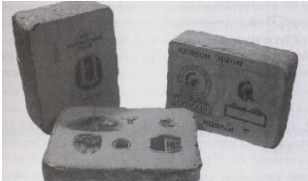
Рис. 1.1 Боварский известняк, используемый в качестве материала для изготовления печатной формы.
