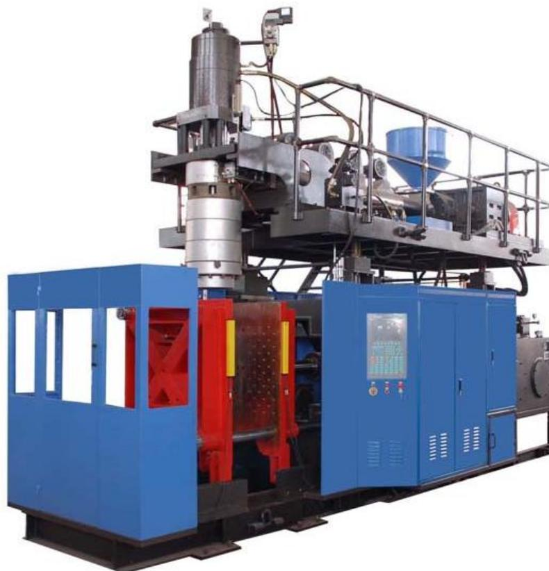
Рисунок Б.2 – Экструзионно-выдувная машина для формования упаковки из полимеров
