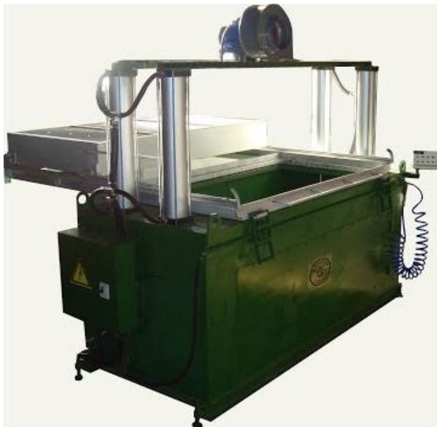
Рисунок Б.4 – Пневно - и вакуумформовочное оборудование для изготовления полимерных изделий
