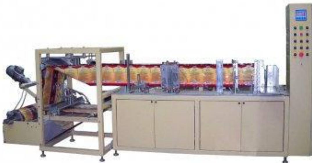
Рисунок Ж.1 – Автомат АИДП для изготовления пакетов типа «Дой-Пак»
