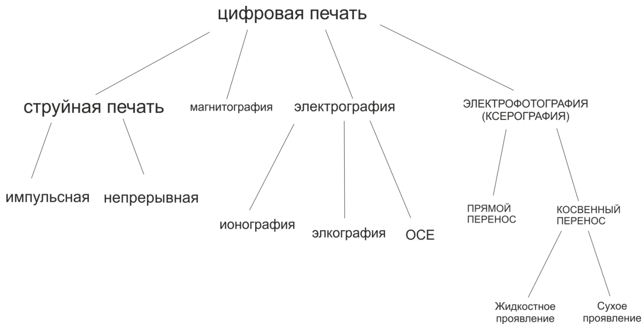
Рисунок А.1 Схема видов цифровой печати.
