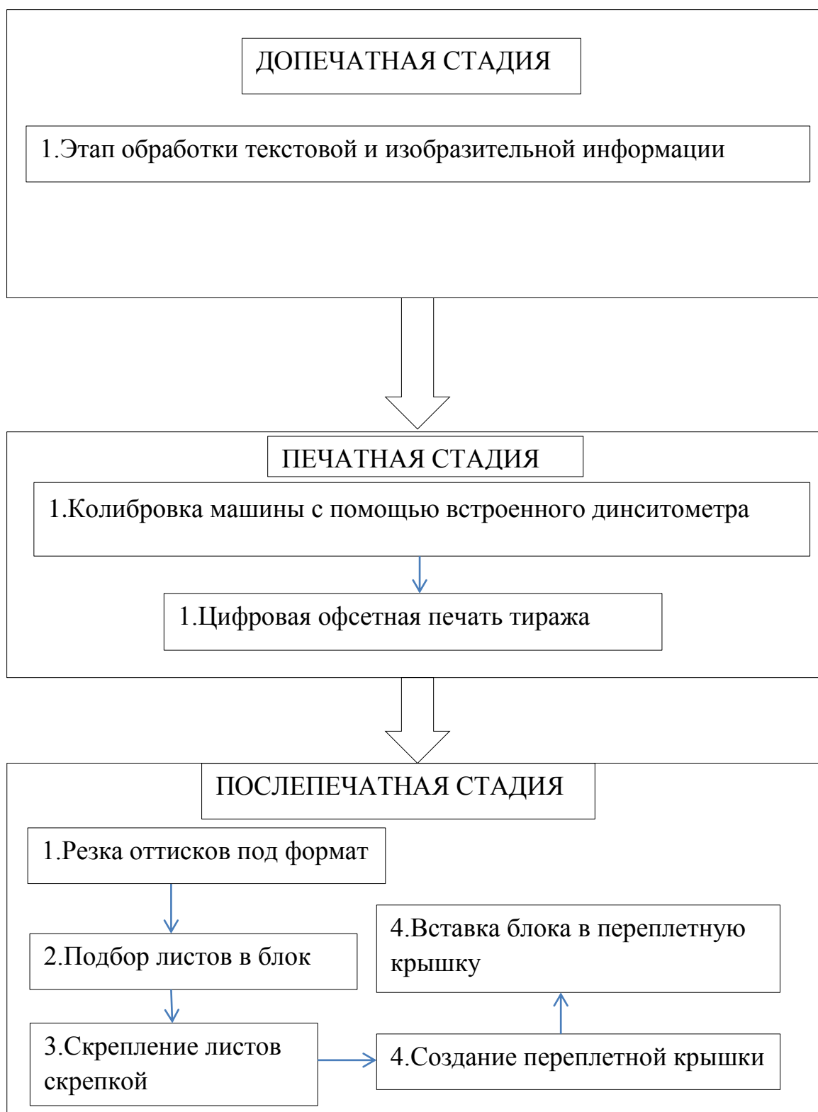
Рисунок М.1 Общая схема производственных процессов
