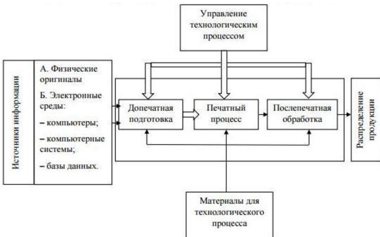
Рисунок X.1 – Характерные информационные и материальные потоки при трафаретной печати
