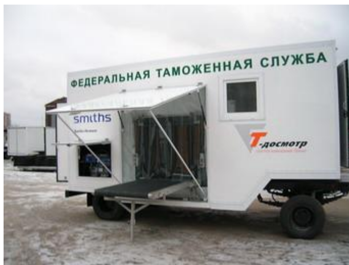
Рисунок 1 – Передвижная рентгенотелевизионная установка ПРТУ 4026
