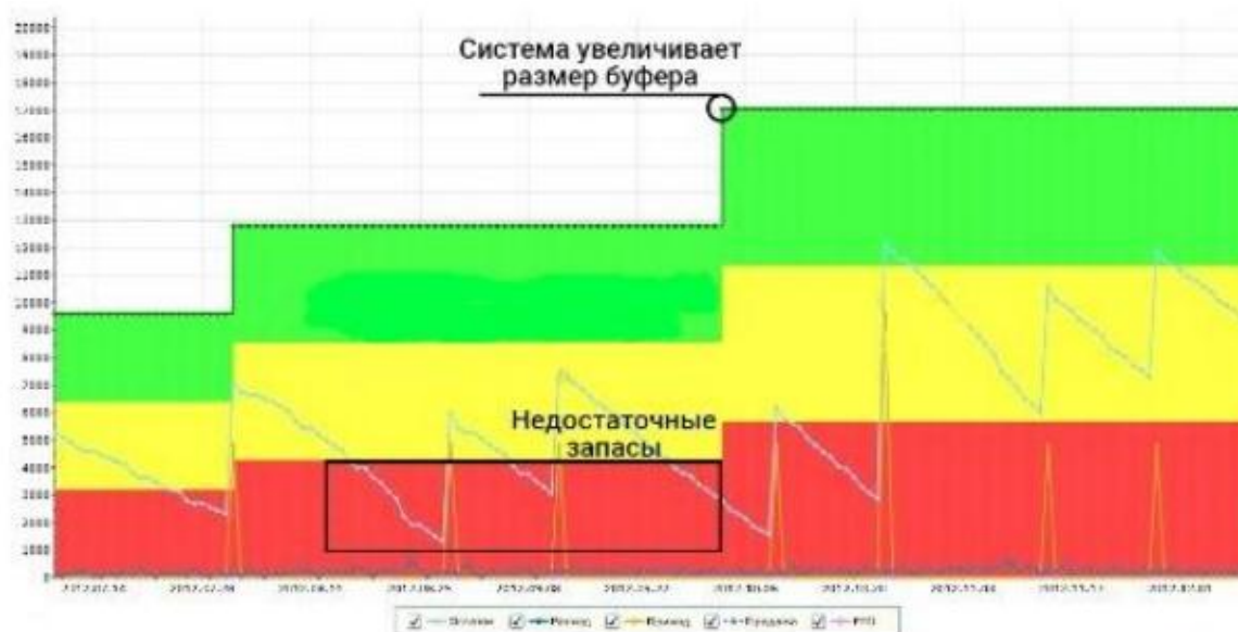
Рисунок 3.9 – Принцип динамического управления – увеличение буфера запасов
