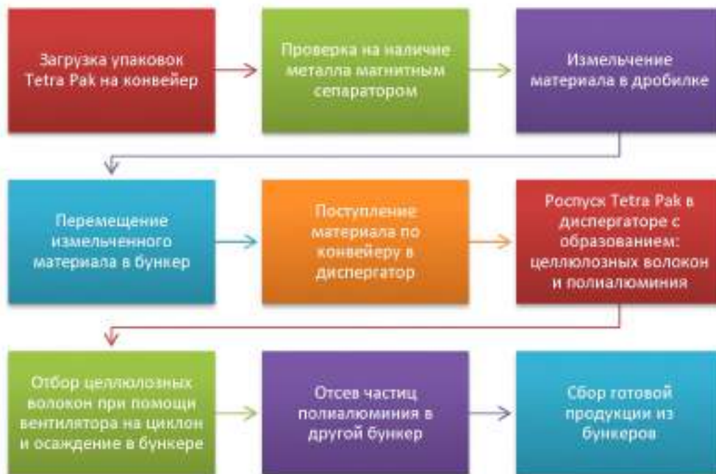
Рисунок 3.5 – Технологический процесс переработки Tetra Pak
