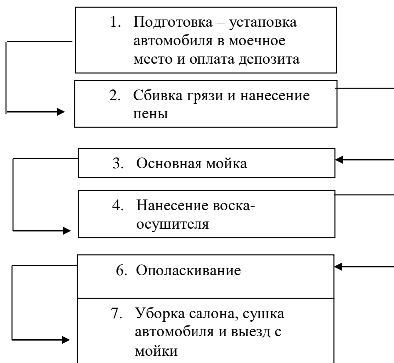
Рисунок 3.3 – Схема осуществления мойки в рамках самообслуживания
