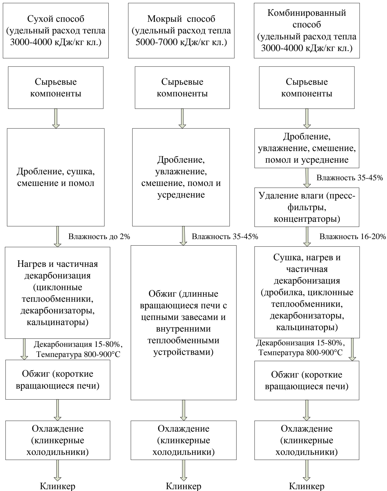
Рисунок 1 – Технологические схемы обжига клинкера
