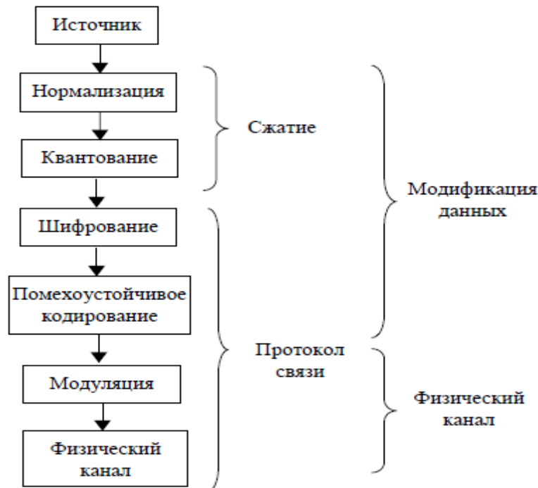
Рисунок 12 – Предложенная автором структурная схема канала передачи данных
