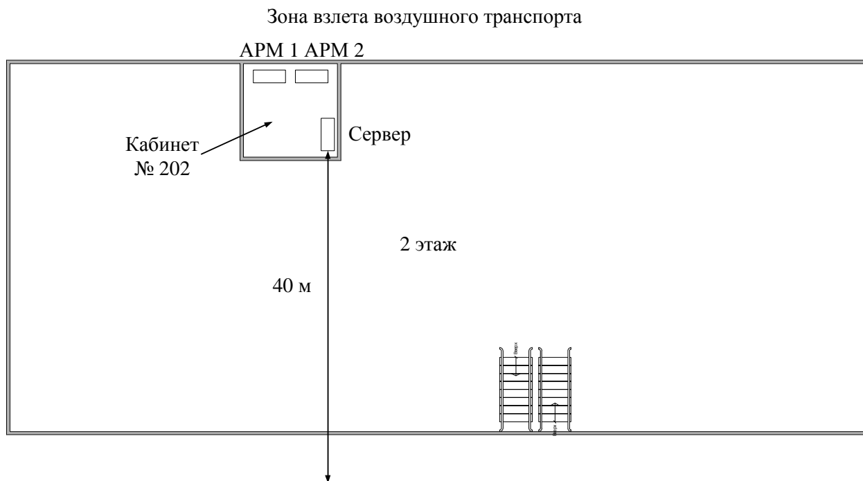
Рисунок 2.3 – Размещение ОТСС относительно границ контролируемой зоны
