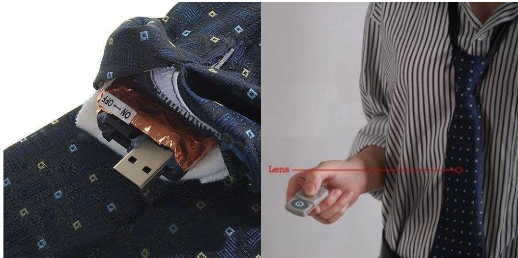
Рисунок 1.11. – Видеокамера «pin-hole», встроенная в галстук.
