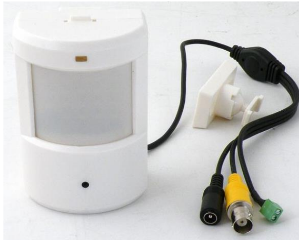
Рисунок 1.10. – Видеокамеры «pin-hole», встроенная в пассивный инфракрасный датчик.
