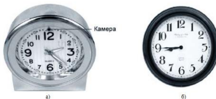
Рисунок 1.9. – Система скрытой видеозаписи на базе цифрового видеорекодера, встроенная в настольные (а) и настенные (б) часы.
