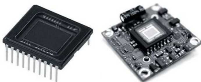
Рисунок 1.4. – Внешний вид миниатюрных матриц ПЗС, используемых в системах скрытого видеонаблюдения.
