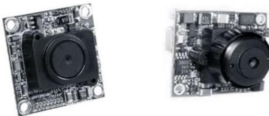
Рисунок 1.2. – Бескорпусные миниатюрные «pin-hole» видеокамеры, используемые в системах скрытого видеонаблюдения
