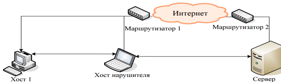
Рисунок 10. Схема угрозы «навязывание ложного маршрута сети» между двумя сегментами
