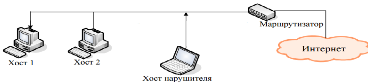
Рисунок 9. Схема угрозы «навязывание ложного маршрута сети» между двумя сегментами
