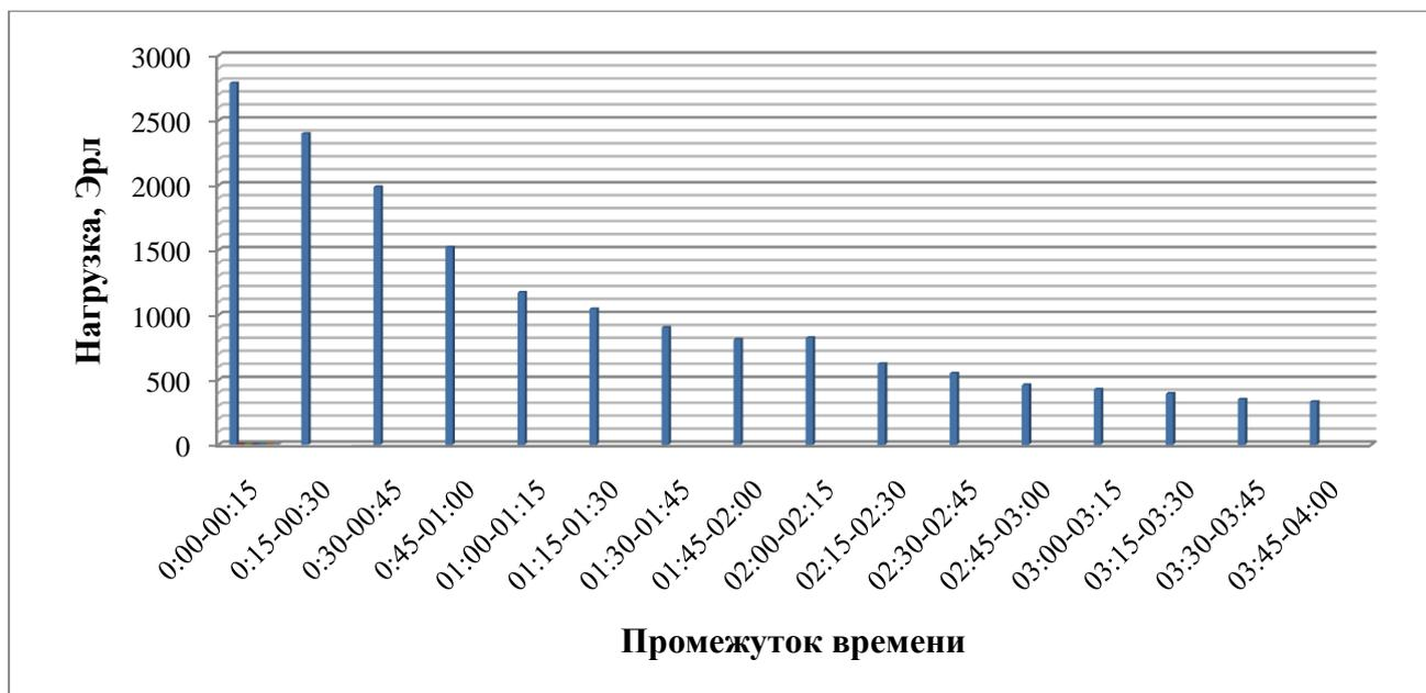
Рисунок 14 – Результаты анализа изменения интенсивности нагрузки 1 января для второго сотового оператора связи
