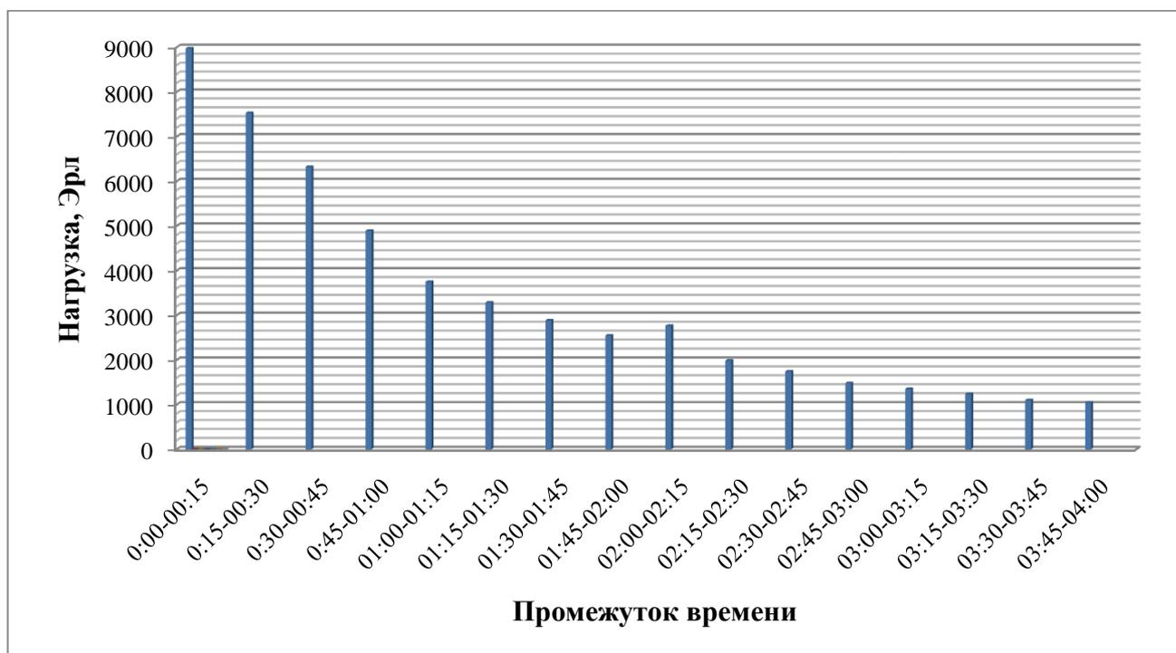
Рисунок 12 – Результаты анализа изменения интенсивности нагрузки 1 января для проводного оператора связи
