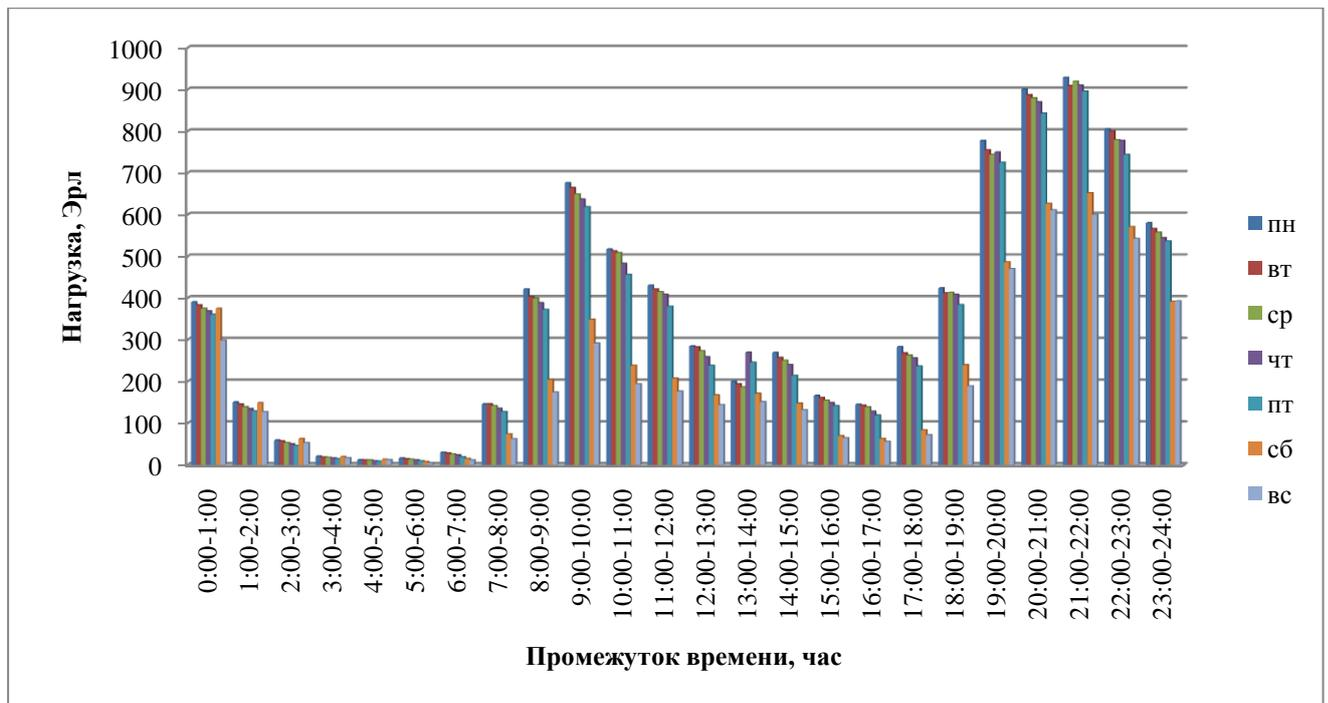
Рисунок 10 – Результаты анализа изменения интенсивности нагрузки в зависимости от времени суток и дня недели для второго сотового оператора связи
