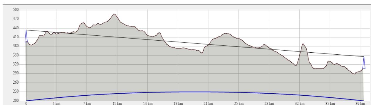
Рисунок 5.9 - Профиль местности РРЛ «Сухтелинский-Арсинский»
