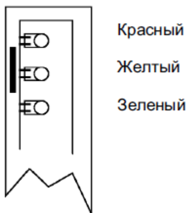
Рисунок 8 – Светодиоды на передней лицевой панели платы CPU-D5
