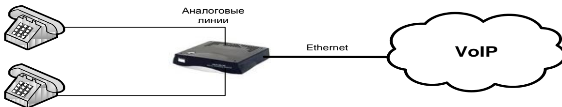
Рисунок 9- Схема тестирования адаптеров VoIP-телефонии
