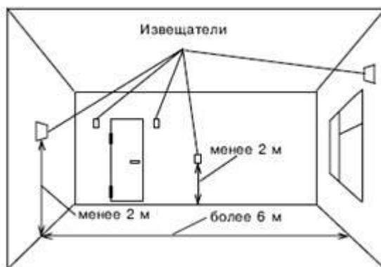
Рисунок 13 - Неправильная установка датчика
