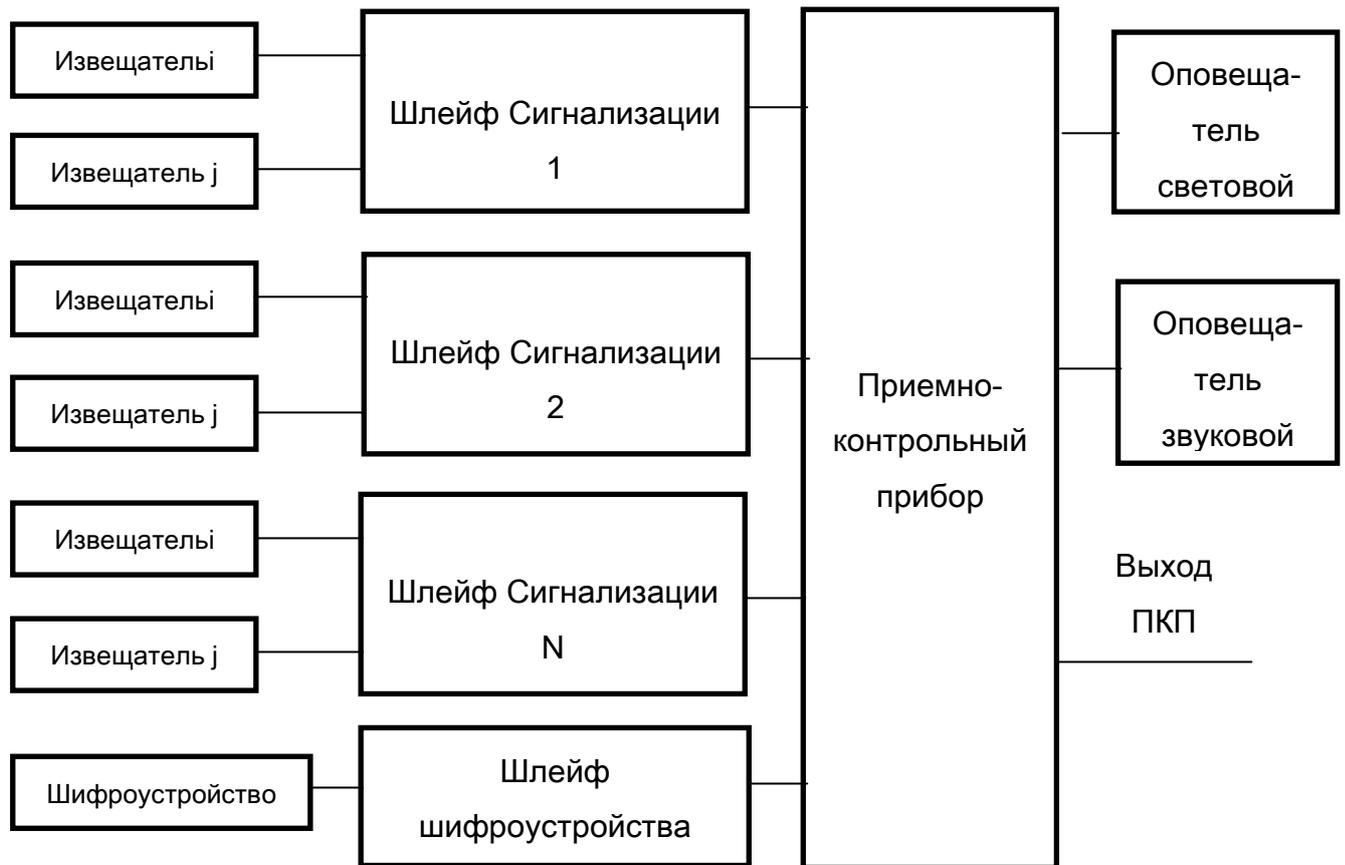
Рисунок 1 - Структурная схема объектовой системы ОПС
