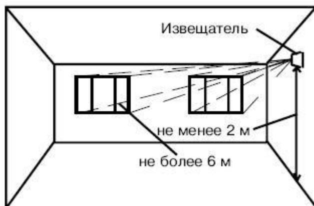
Рисунок 10 - Вариант установки датчика на боковой стене
