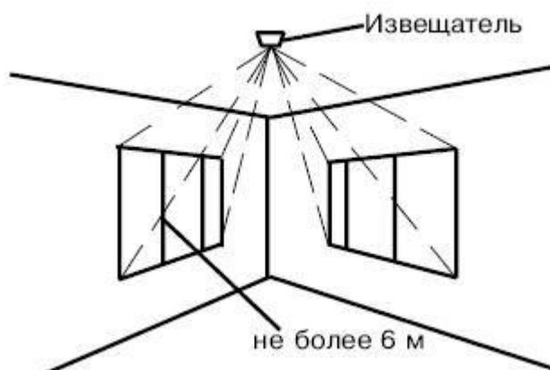
Рисунок 12 - Вариант установки датчика на против окон
