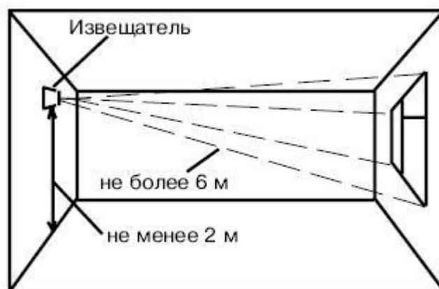
Рисунок 11 - Вариант установки датчика на против окна
