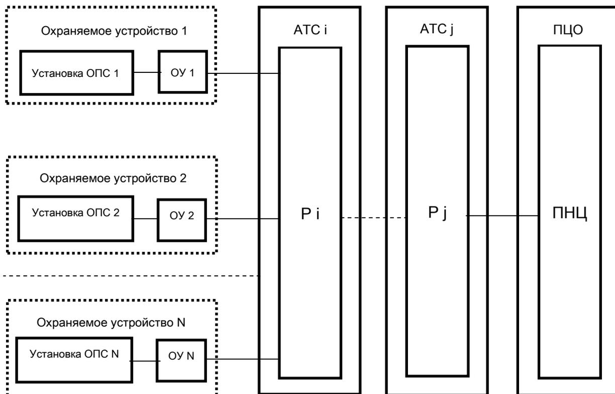
Рисунок 2 - Структурная схема системы централизованной сигнализации.
