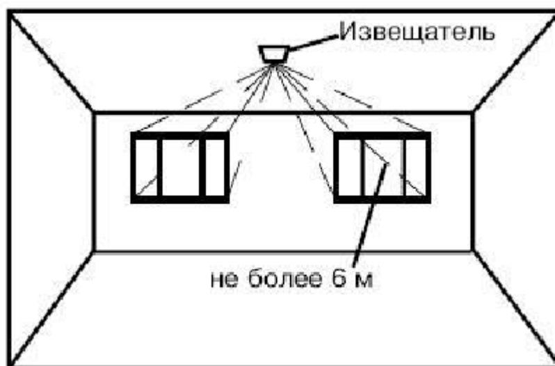
Рисунок 9 - Вариант установки датчика на потолке
