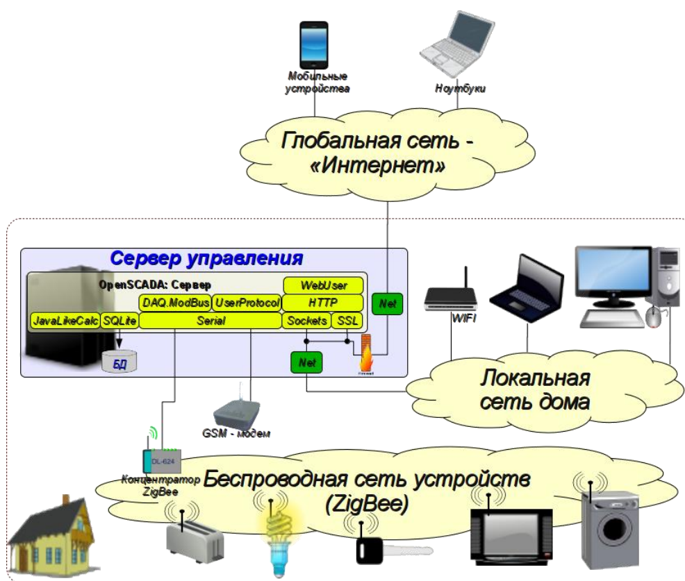
Рисунок 2 – Архитектура сети ZigBee
