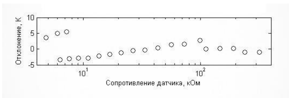
Рисунок 18 – Отклонение экспериментальных точек от теоретической кривой
