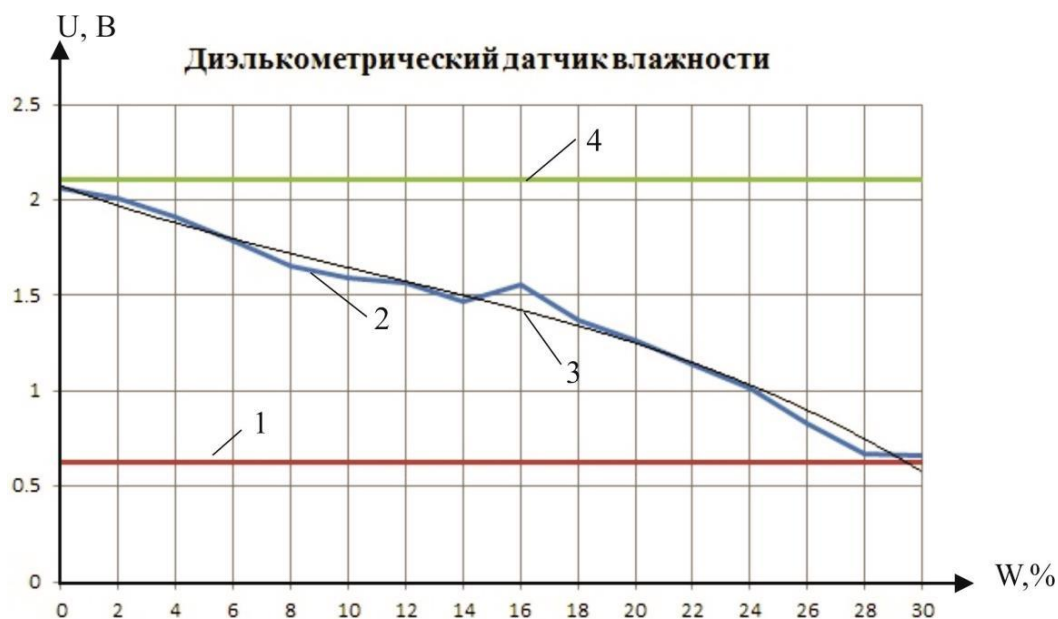
Рисунок 3.3 – Зависимость выходного напряжения от влажности для диэлькометрического датчика влажности почвы:
