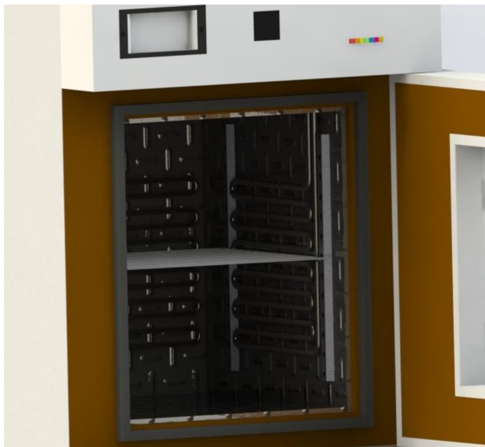
Рисунок 2.6 – модель предлагаемой конструкции емкости климатической камеры
