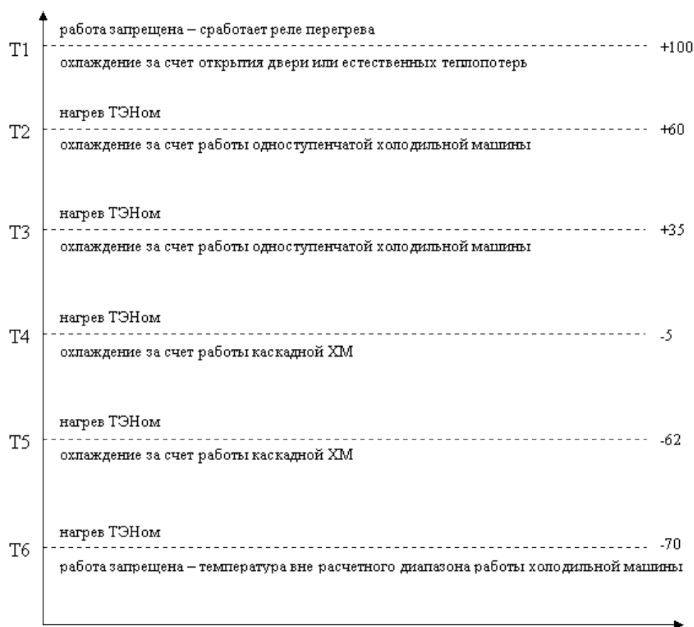
Рисунок 1.3 – температурные зоны работы устройств камеры
