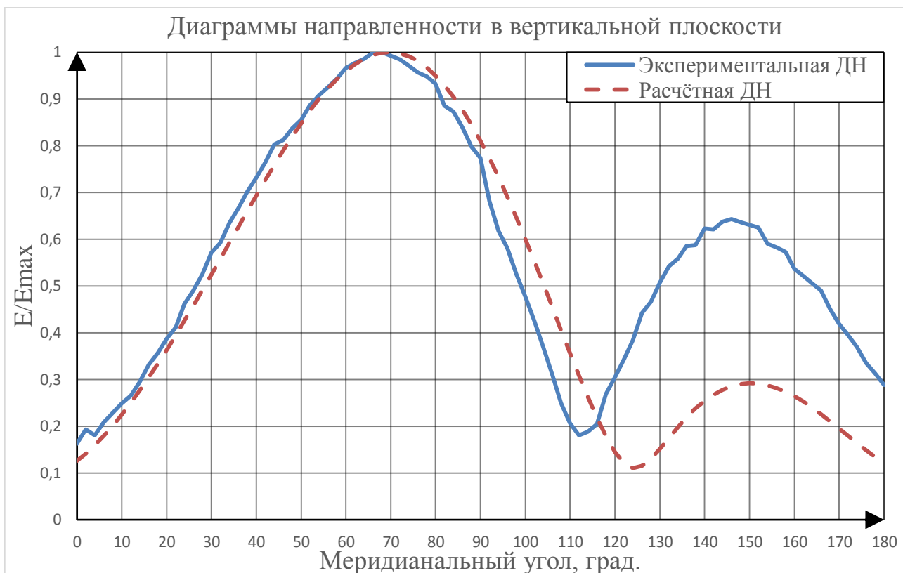
Рисунок 3.37 – Расчётная и экспериментальная диаграммы направленности первого варианта
