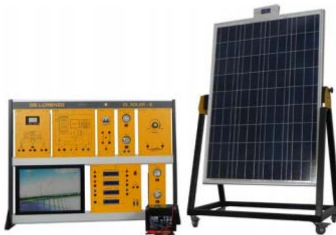
Рисунок 1.2 – Модель фотоэлектрической станции «DL SOLAR-B»
