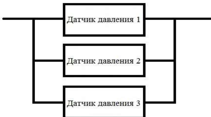
Рисунок 2.11 – Параллельная структура надежности датчиков давления
