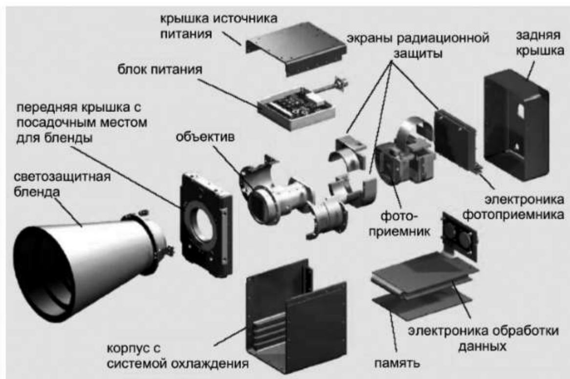
Рисунок 2.2 – Основные элементы астродатчика
