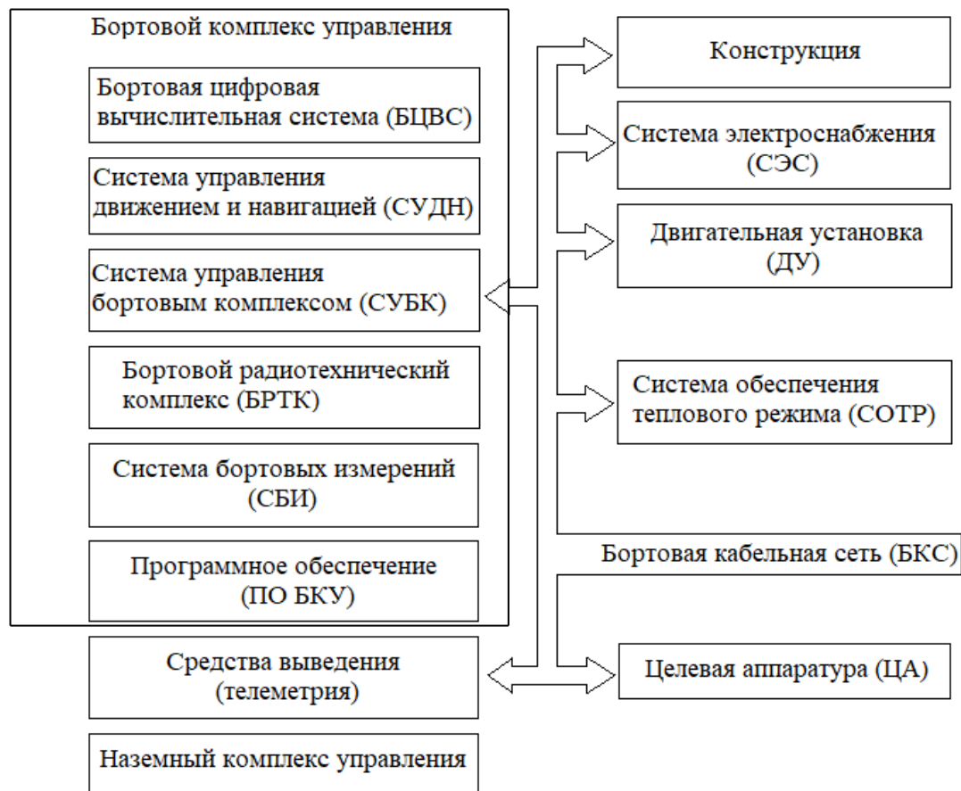
Рисунок 1 – Бортовой комплекс управления автоматических космических аппаратов
