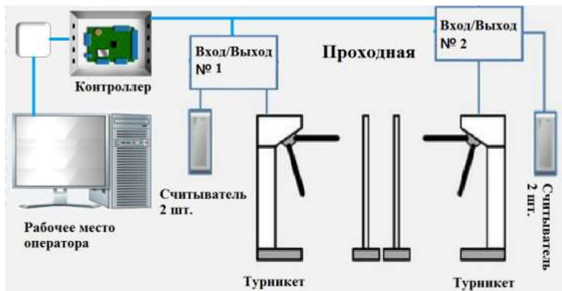
Рисунок 2.1 – Схема автоматизированной проходной
