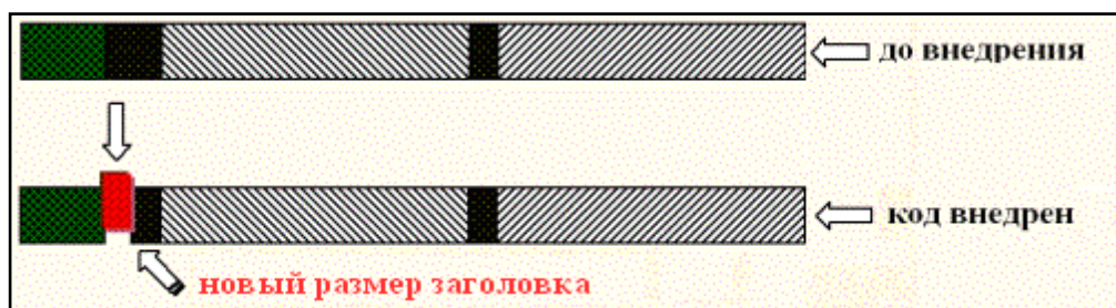
Рис. 3. Внедрение информации в свободное пространство хвоста PE-заголовка
