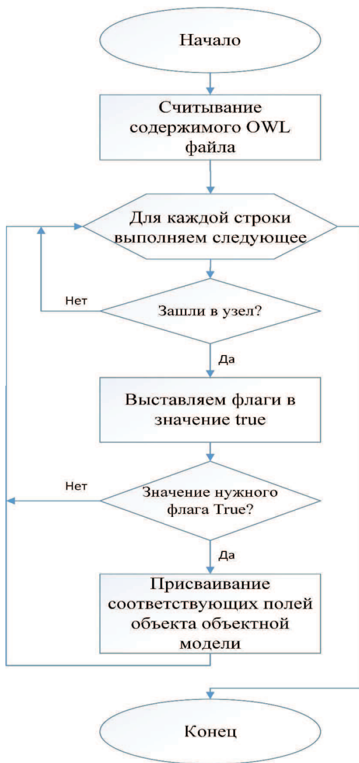
Рисунок 2.4.1 – Блок-схема алгоритма конвертации из файла OWL в объектную модель
