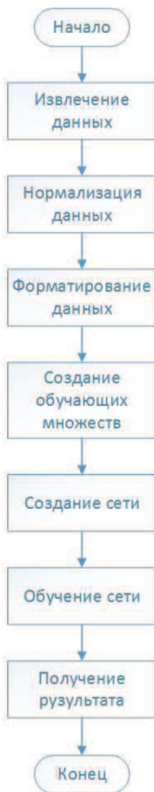
Рисунок 34. Алгоритм работы анализатора
