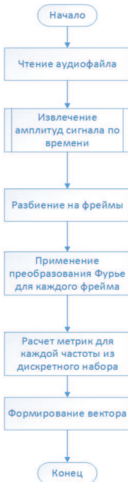
Рисунок 30. Блок-схема алгоритма перевода аудиофайла в вектор значений
