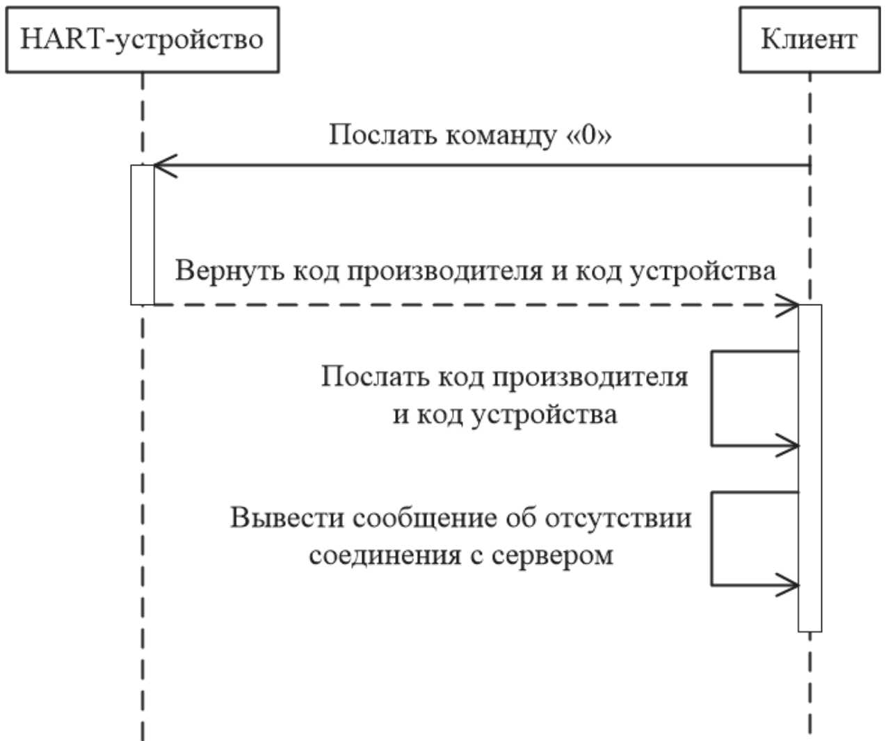
Рисунок 7 - Работа системы при отсутствии связи между клиентом и сервером
