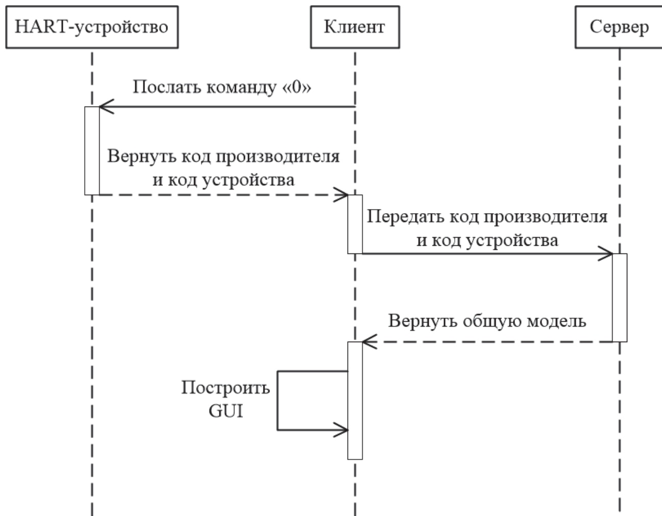
Рисунок 6 - Работа системы при отсутствии информации об устройстве
