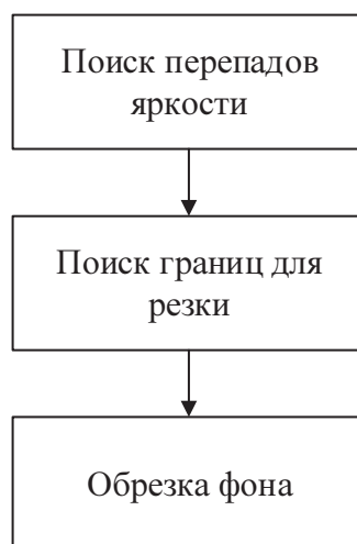
Рисунок 4.5 – Алгоритм обрезки изображения
