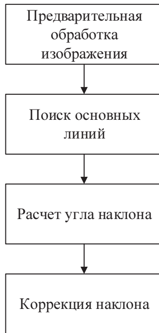
Рисунок 4.6 – Алгоритм коррекции угла наклона по основным линиям
