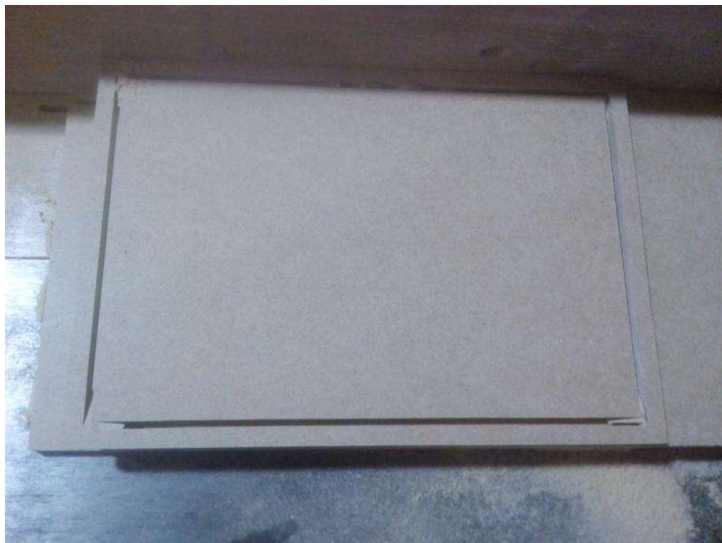
Рисунок В.1 — Заготовка основания рамки в процессе резки
