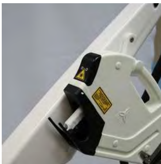
Рисунок 7 — Эрбиевая лазерная насадка с SMA модулем.
