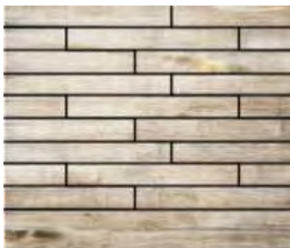
Рисунок 39 — Схема расположения досок «вразбежку»
