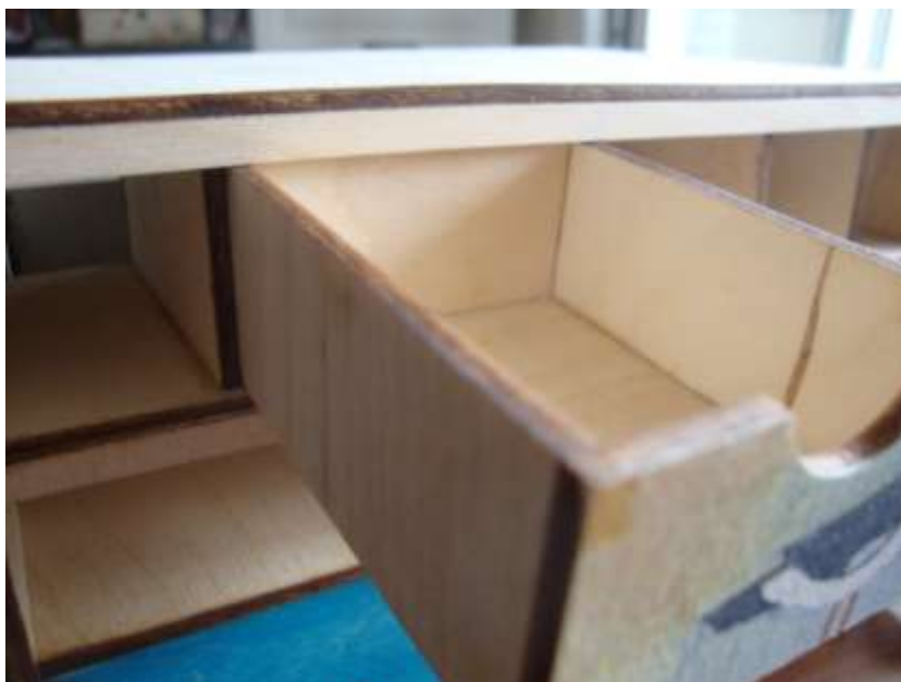
Рисунок 24 — Стоп-панель и максимально выдвинутый ящик комодика
