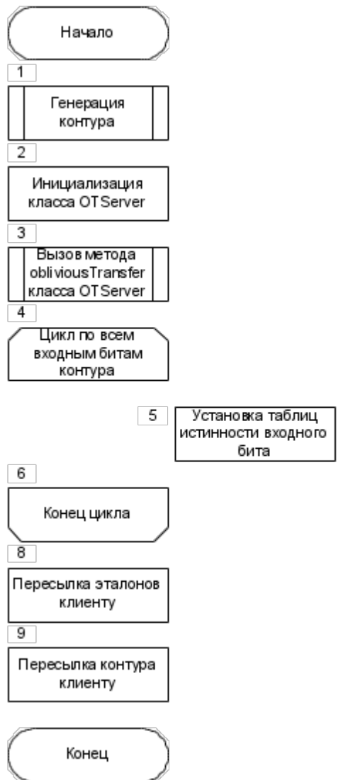
Рис. 5. Схема работы sendGate
