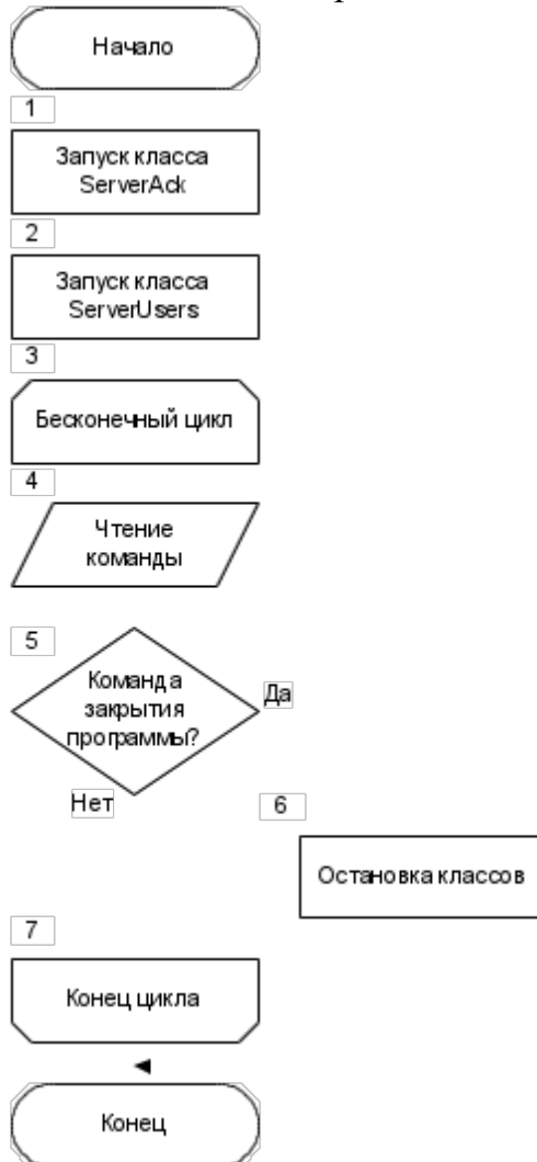
Рис. 2. Схема работы serverMode.
