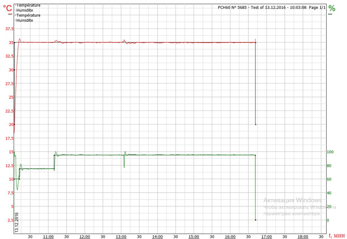
Рисунок.2.8. Программа испытаний повышенной влажности в транспортной таре при  $T = +35^{\circ}\text{C}$  при 95% влажности воздуха (для всех приборов)
