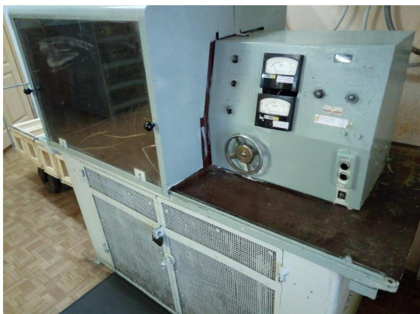
Рисунок 2.3. Высоковольтная пробойная установка
