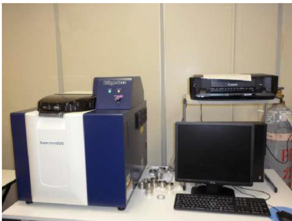
Рисунок 2.3 – Общий вид спектрометра рентгенфлуоресцентного волнодисперсионного Supermini 200
