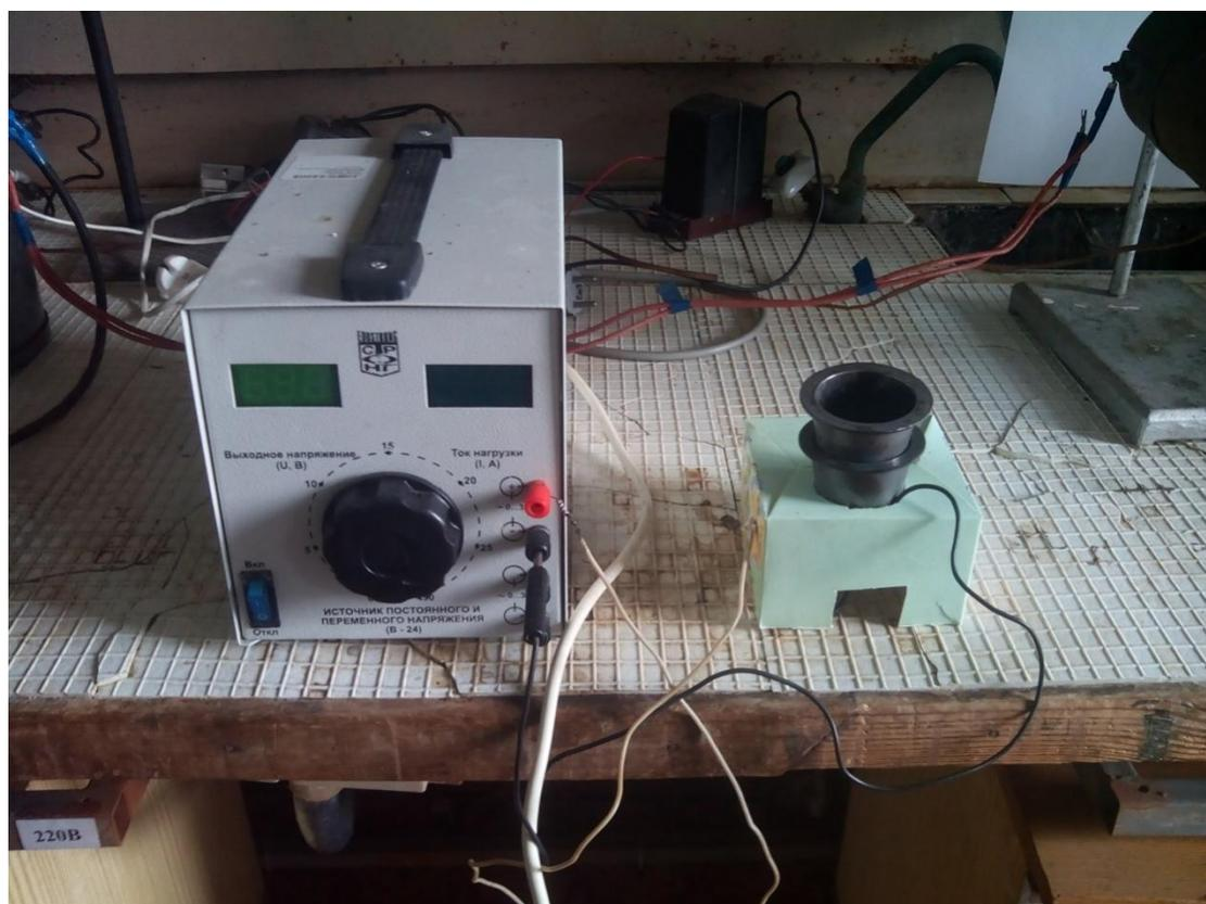
Рисунок 7– Внешний вид установки электрохимического интеркалирования
