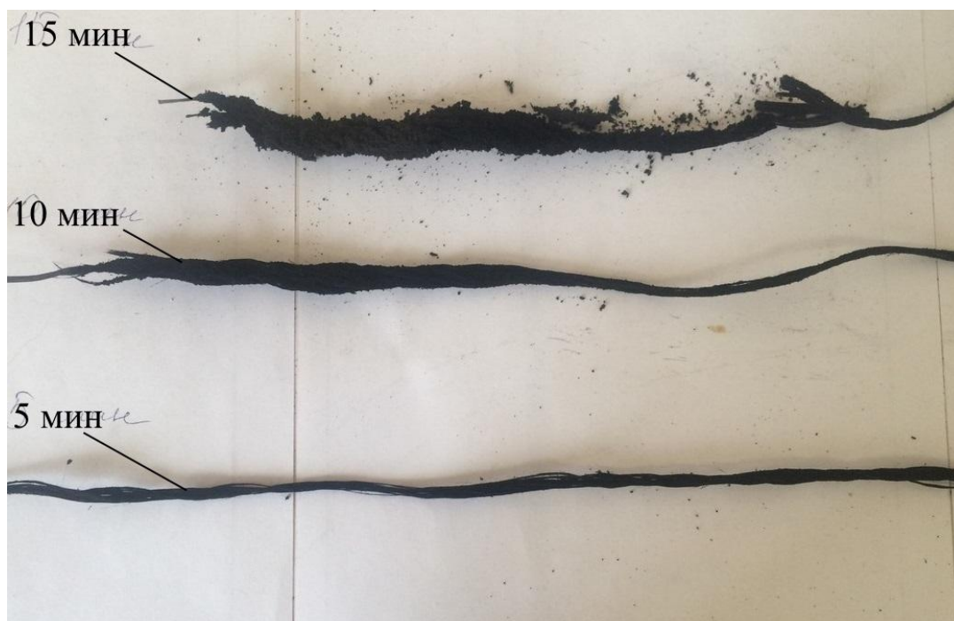
Рисунок 3.1 – Внешний вид углеродных волокон после синтеза на 8 слоях катализатора концентрацией 0,5 М в течение 15, 10 и 5 минут
