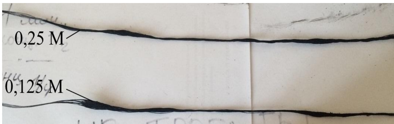
Рисунок 3.2 – Внешний вид углеродных волокон после синтеза на 1 слое катализатора концентрациями 0,25 М и 0,125 М в течение 1 минуты
