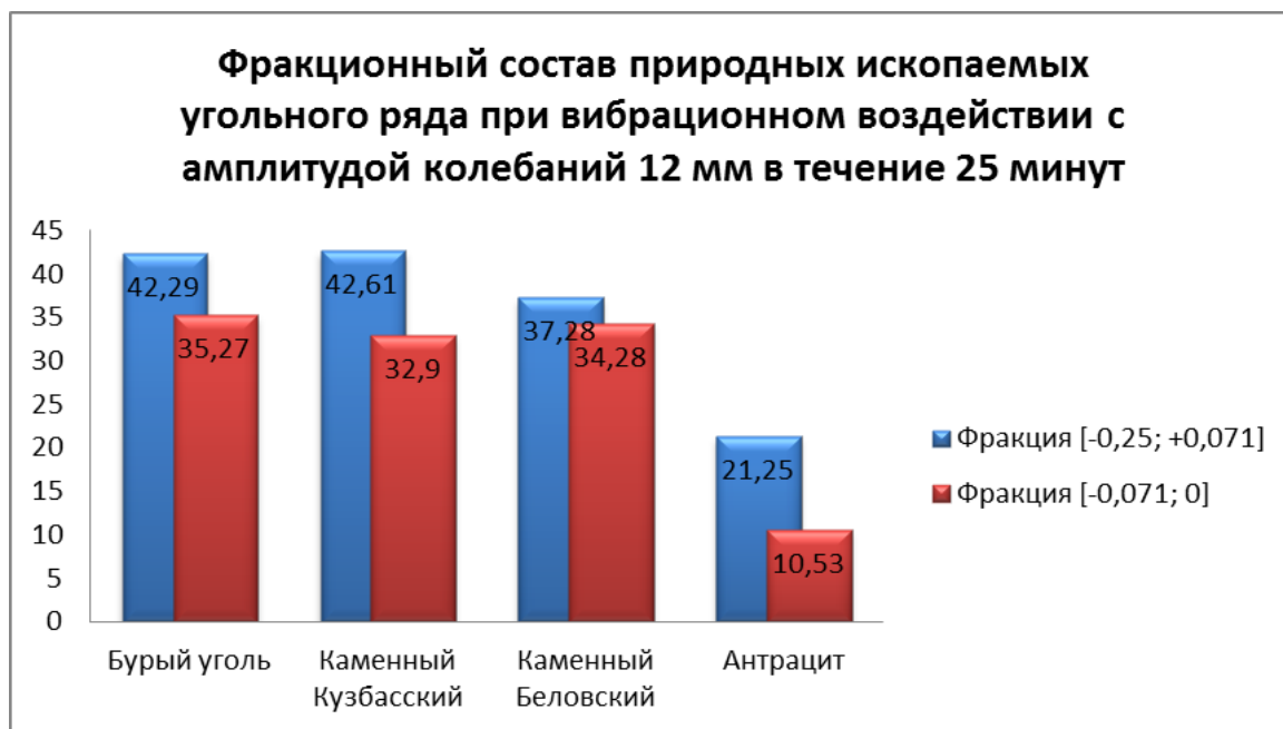
Рисунок 9 – Диаграмма сравнения выхода двух фракций природных углеродсодержащих материалов разной степени метаморфизма после измельчения
