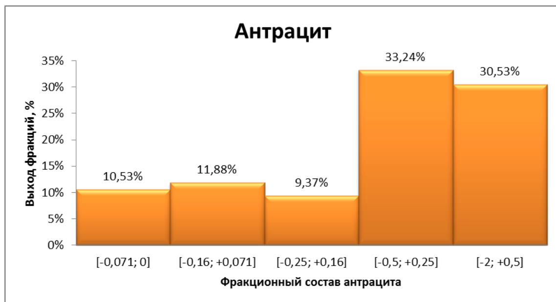
Рисунок 8 – Диаграмма зависимости фракционного состава антрацита от выхода фракций, %
