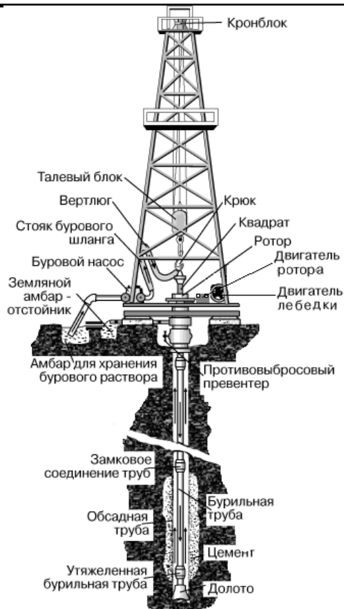
Рисунок 1.1 – Схема установки для бурения глубоких скважин.
