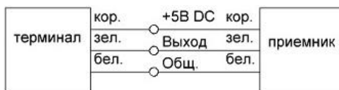
Рисунок 15 – Схема подключения датчика ТЕКОВ ТИЮ.5161
