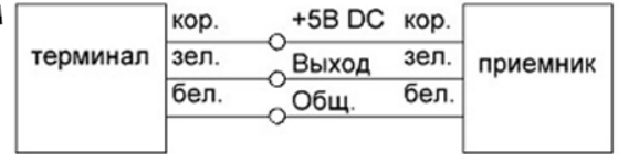
Рис. 9.2 Схема подключения датчика ТЕКО ВТИЮ.5161
