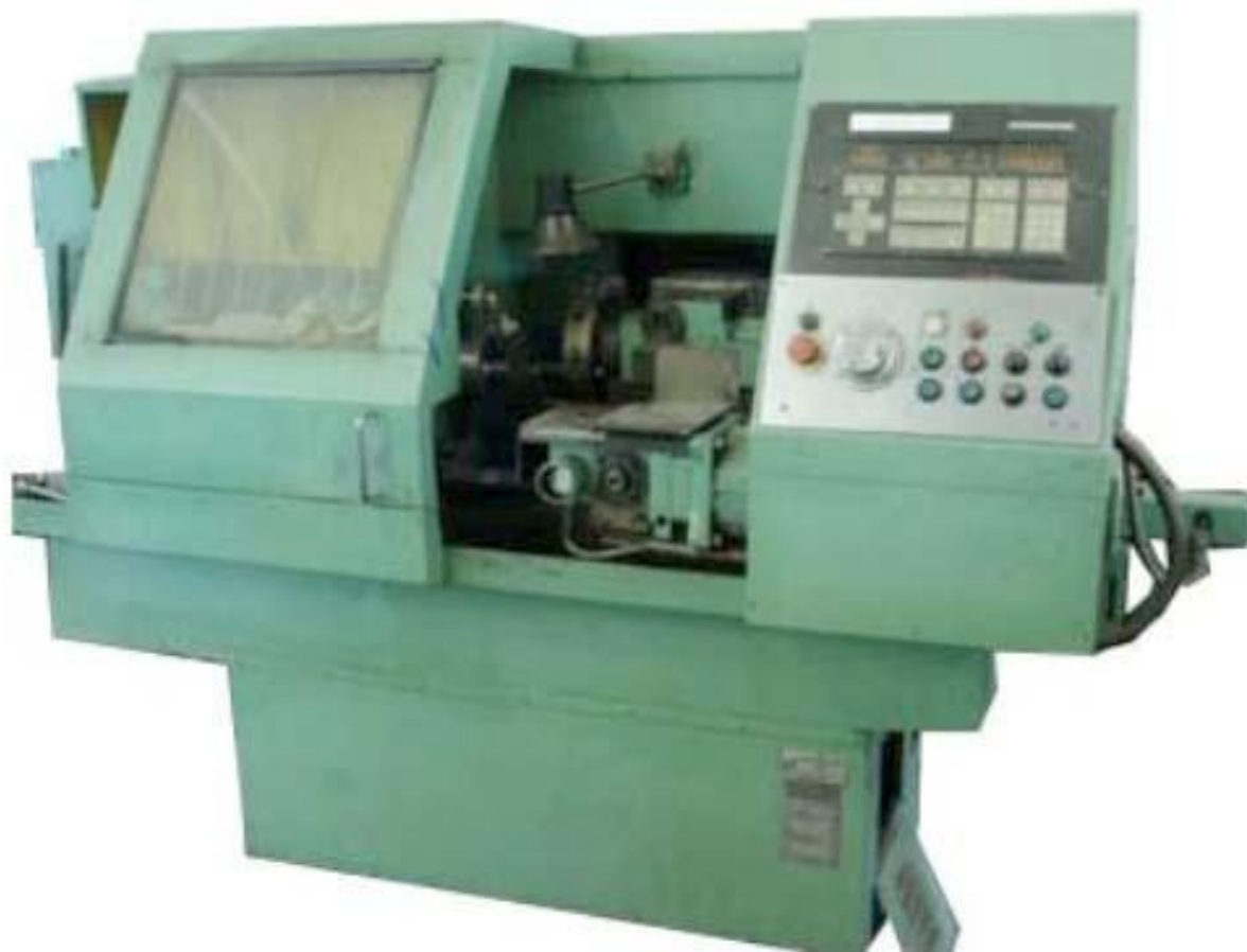
Рисунок 1.1 – Общий вид станка с ЧПУ 1325Ф30
